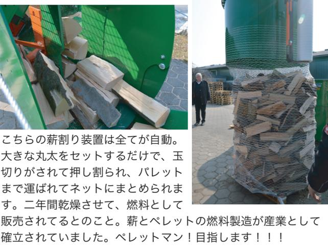
こちらの薪割り装置は全てが自動。大きな丸太をセットするだけで、玉切りがされて押し割られ、パレットまで運ばれてネットにまとめられます。二年間乾燥させて、燃料として販売されてるとのこと。薪とペレットの燃料製造が産業として確立されていました。ペレットマン! 目指します!!!
